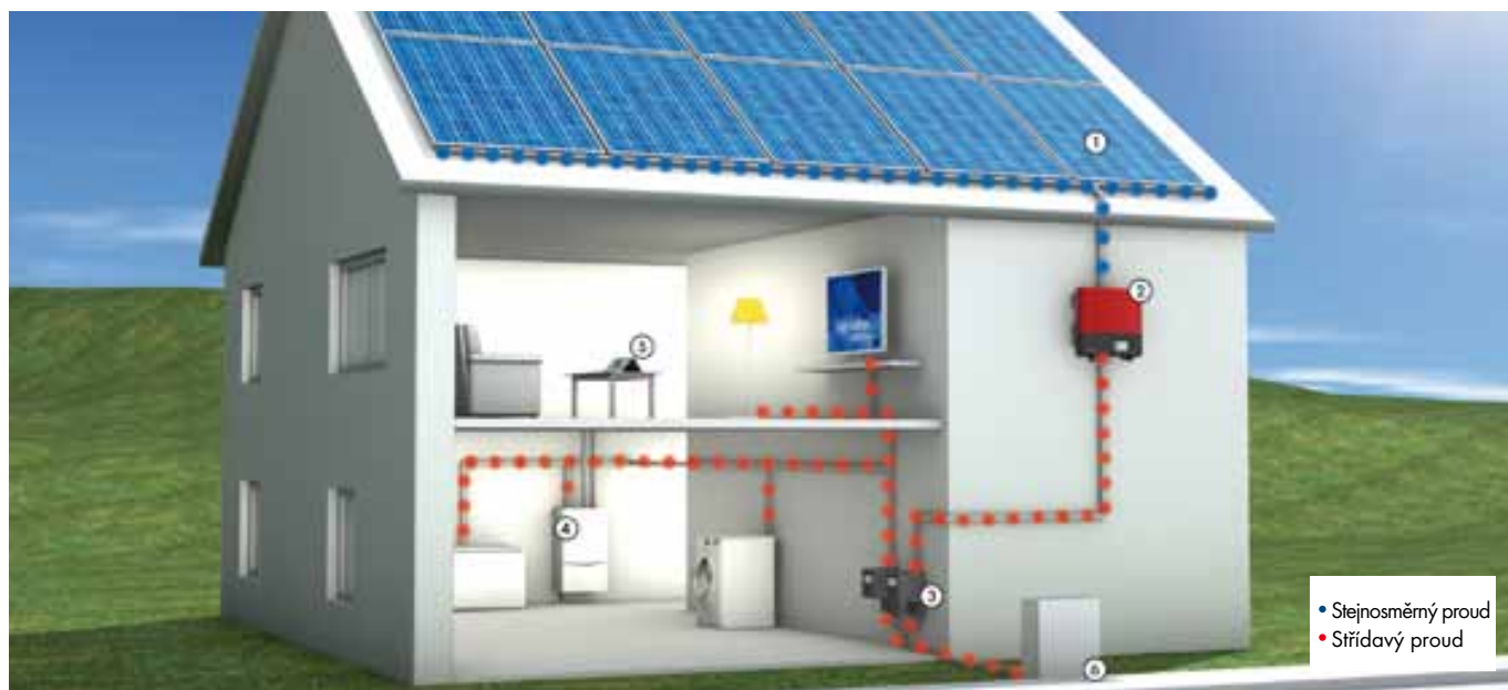
Komponenty: 1. FV panel, 2. FV střídač Sunny Boy, 3. elektroměr pro měření dodávky do sítě, 4. spotřebič, 5. přístroj Sunny Beam, 6. připojení k rozvodné síti
