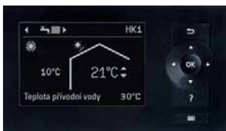
Displej regulace tepelného čerpadla Vitotronic 200.
