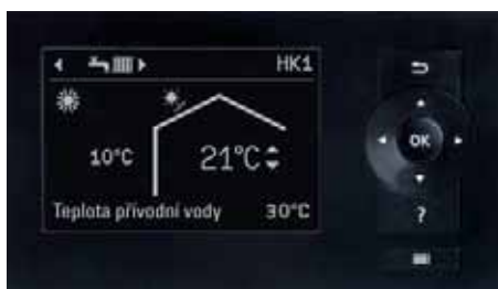
Displej regulace tepelného čerpadla Vitotronic 200.
